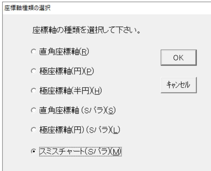
スミスチャート (Sパラ) の設定ダイアログが表示されるので、必要な項目を入力する。
