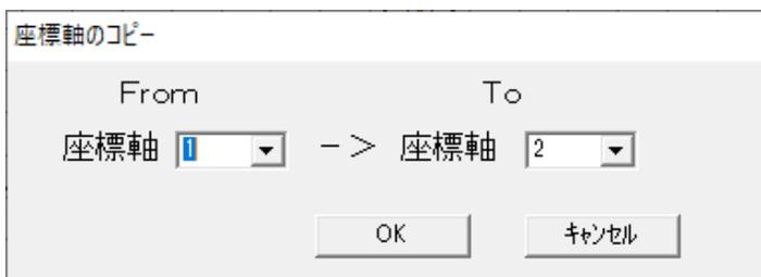
すると、現在の座標軸[1]が座標軸[2]にコピーされるが、下図のとおり両方の座標軸が重なって表示される。
